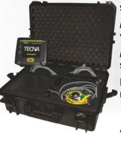
Mesure de la valeur d'énergie pour le point soudé et valeur de la résistance électrique;
